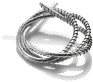
Spanbildung mit herkömmlicher Bearbeitung Formation du copeau par un usinage conventionnel
