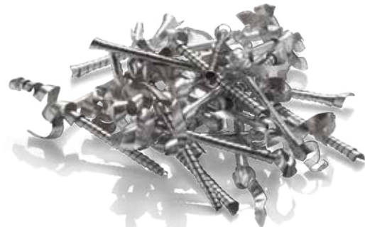
Spanbildung mit High-Frequency-Turning Formation du copeau avec High-Frequency-Turning
