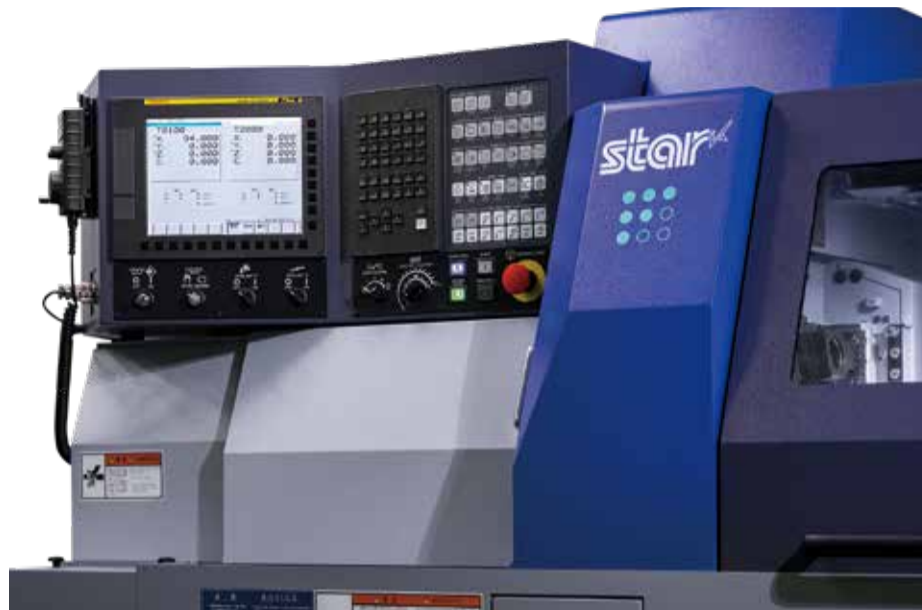
Le panneau de commande est doté d'un écran CN orienté vers l'opérateur pour une meilleure visibilité pendant les opérations.
