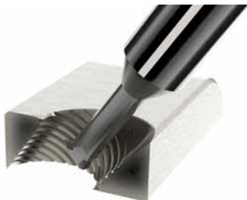
Tourbillonnage d'un filet conique à cinq entrées.
