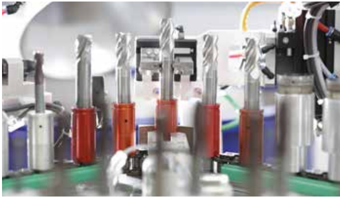
Changement automatique des pièces à usiner avec un chargeur à chaîne. Automatischer Werkstückwechsel mittels Kettenlader. Automatic change of workpieces using a chain loader.
