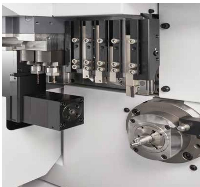
das Modell L20XII mit ATC-Werkzeugen eingesetzt werden, die mit den bereits vorhandenen Drehwerkzeugen und angetriebenen Werkzeugen kombiniert werden, um Querbearbeitungsvorgänge ausführen zu können.
