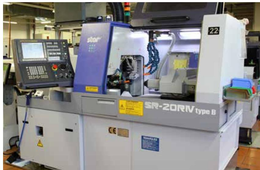
Grâce à leur construction à l'ancienne, avec notamment un châssis en fonte, les machines Star de la série SR font partie des machines les plus stables du marché.
