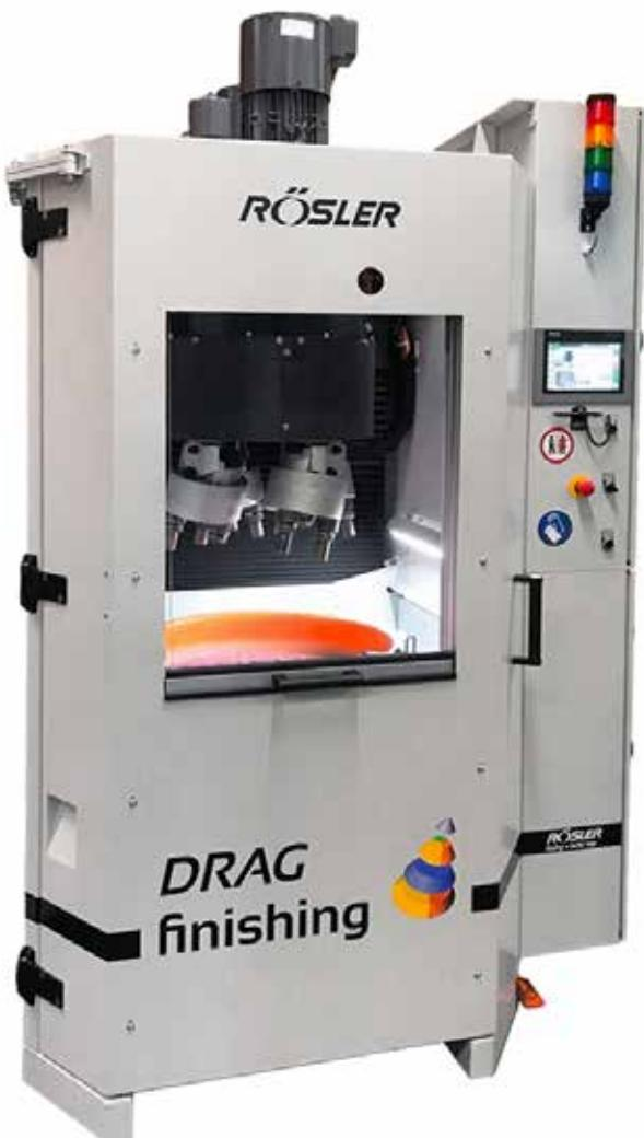
La machine de finition à la traîne R 4/700 SF, compacte et d'application universelle, dispose d'un carrousel avec quatre broches de travail pour trois pièces chacune. Des entraînements séparés pour la cuve de travail et les broches permettent de régler leurs mouvements individuellement et indépendamment les uns des autres. Pour un chargement ergonomique, simple et rapide des broches de travail, la machine peut être amenée en position de chargement par simple pression sur un bouton.
