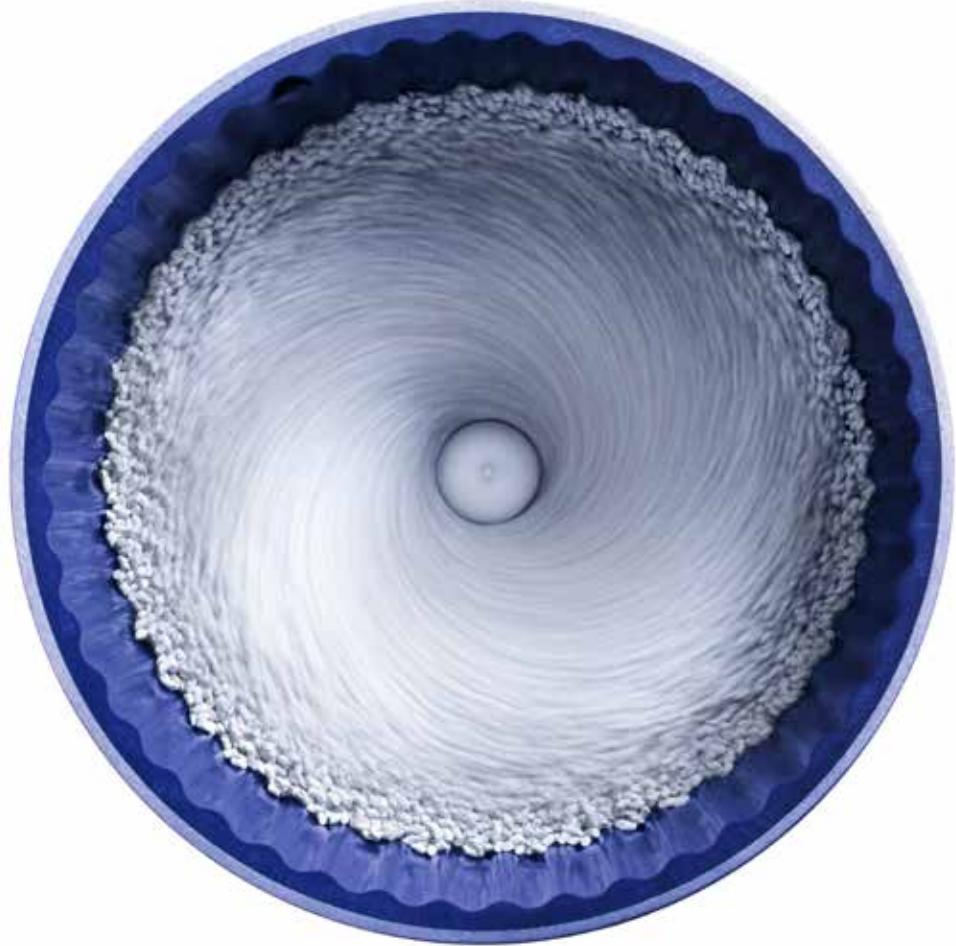
Die Auswahl der Form der Schleifkörper richtet sich nach der Geometrie des zu bearbeitenden Werkstückes. Auch gibt es Verfahren, bei denen in einem Arbeitsgang sowohl geschliffen als auch poliert werden kann. Dadurch wird das Separieren zwischen den Arbeitsschritten eingespart.
