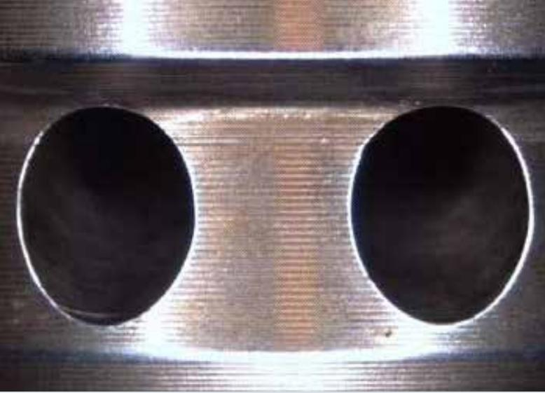
Après traitement: le temps de traitement a été de 30 minutes. En choisissant le granulat de rectification adapté et aux bonnes dimensions, on a pu obtenir ici un ébavurage à 100% des perçages.
