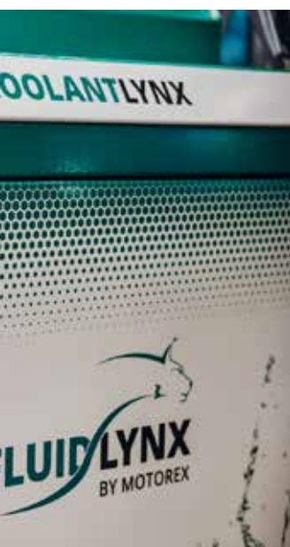
Une équipe forte : le Fluidlynx combiné avec le Coolantlynx, qui mélange, dose, remplit et sépare l'huile étrangère du réfrigérant lubrifiant. Toutes les valeurs mesurées et les mouvements sont visibles en ligne.
