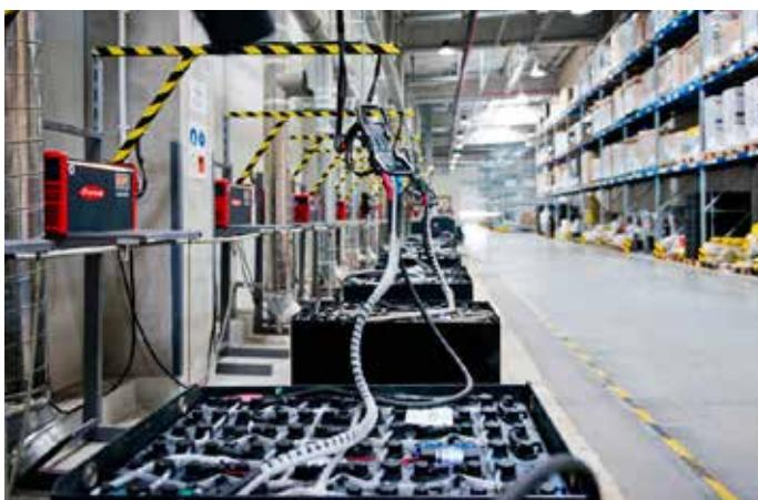
Une bande LED sur le système de charge de la batterie permet à l'utilisateur de savoir immédiatement quelles batteries sont complètement chargées et suffisamment froides pour être utilisées. Le résultat est une utilisation égale des chariots élévateurs et des batteries.
