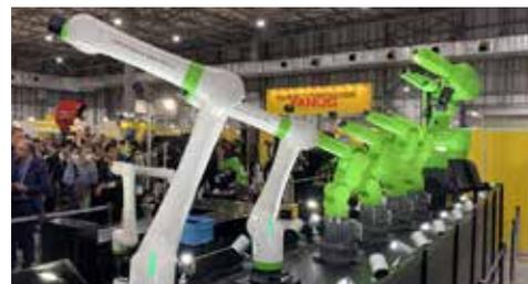
En version à bras court avec une portée de 1,2 mètre et en version à bras long avec un bras atteignant jusqu'à 1,4 mètre. La capacité de charge est de 10 kilogrammes chacun.
