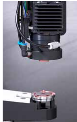
Système de caméra (à gauche) pour déterminer la position et l'orientation de la pièce.
