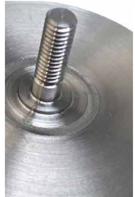
Soudage laser: axe sur réservoir en titane. Laserschweißen: Achse auf Titanbehälter. Laser welding: axis on titanium tank.
