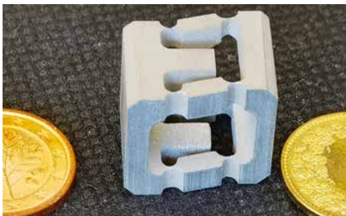
Structure monolithique tridimensionnelle, découpée au jet d'eau à partir d'un profilé en aluminium extrudé dont les dimensions latérales sont de 12,4 x 20 mm (Photo : Klaus Vollrath).
