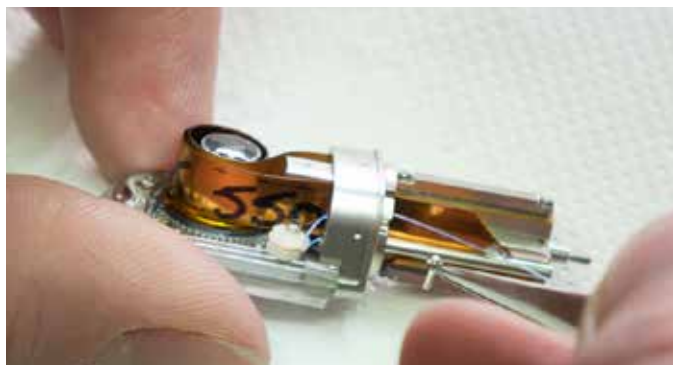
Assemblage d'une sonde d'échographie cardiaque.
