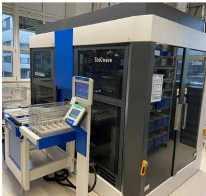
La gamme complète de systèmes de nettoyage offre des solutions pour toutes les tâches de nettoyage tout au long de la chaîne de production. Ci-dessus un système de nettoyage aqueux pour le nettoyage intermédiaire, par exemple de pièces de fabrication avant le revêtement de surface. Source de l'image : Philips Medical Systems.
