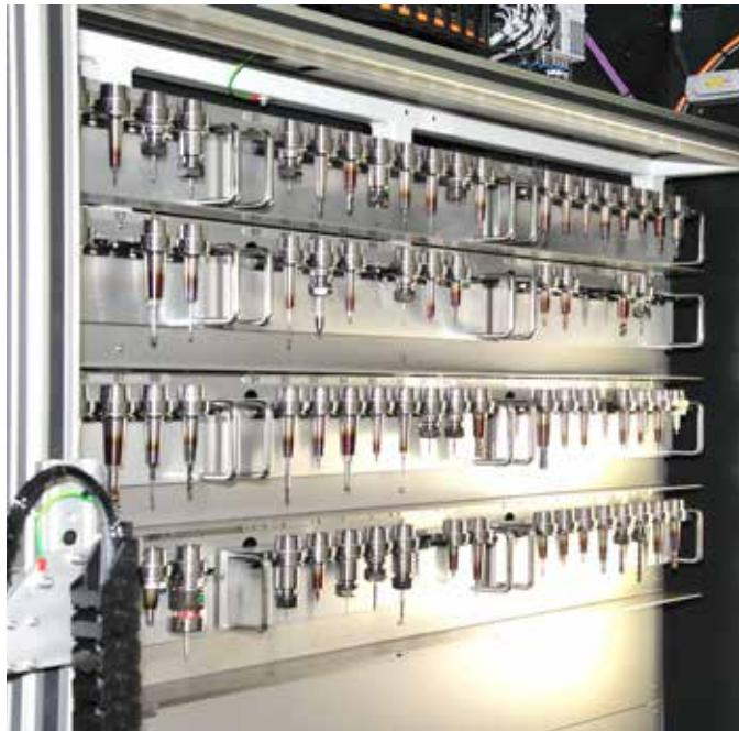
Bien équipé: Cemec utilise souvent les 210 espaces du changeur d'outils de la Kern Micro HD pour ses tâches d'usinage complexes.
