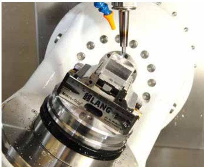
*rendu possible par la combinaison de la fraiseuse de haute précision et de nos connaissances*, souligne Martin Schwab: «Avec la Kern Micro HD, nous obtenons une planéité inférieure à 800 nm et pouvons retravailler des microns si nécessaire.»
