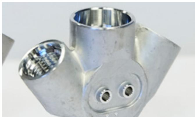
Une pièce brute forgée en un alliage d'aluminium spécial, contenant du silicium (AlSi05), fait office de matériau de base.
