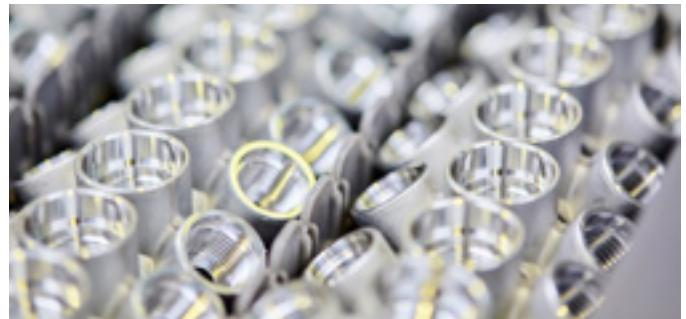
Précision de haut niveau : L'ouverture H7 constitue un bon exemple de précision, elle peut en effet être fraîsée à 14 µm exactement.
