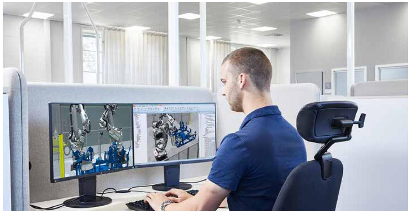
La programmation hors ligne est le meilleur moyen de maximiser le retour sur investissement des systèmes robotiques. Le logiciel de simulation et de programmation hors ligne d'ABB Robotics, RobotStudio, permet la programmation et la simulation en temps masqué sur PC.
